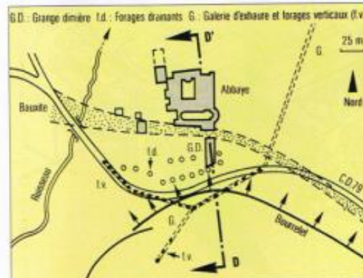
Fig. IV-4 IDEM – Plan des ouvrages drainants. (Les dessins sont de G. Colombet, G. Kock-Paquier, M. Poosz, C. Vibert).
